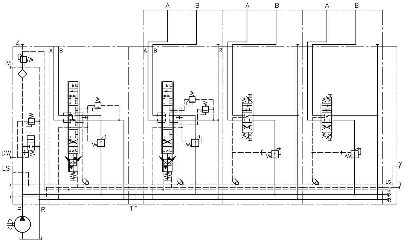
Пример заказа 3: управление PSV для подачи напорного масла регулируемым насосом.
