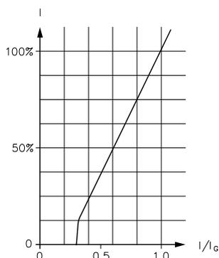
Рисунок 7: Ток управления ( $I, I_G$ ); ход золотникового распределителя (%)
