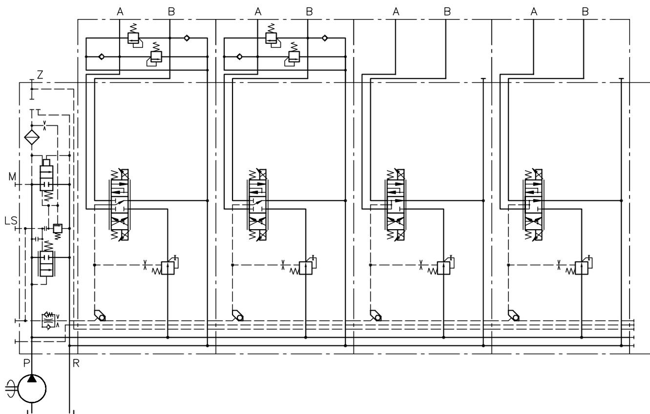
Пример заказа 2: управление PSV для подачи напорного масла регулируемым насосом.
