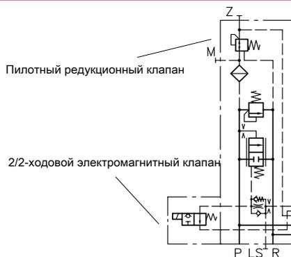
Соединительный блок для систем с нерегулируемым насосом со встроенным 3-ходовым регулятором потока, предохранительным клапаном и отключением сигнала нагрузки
