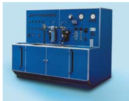
Стенд для проведения многопроходного испытания
